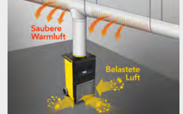
DualHeat-Ausblasturm für gleichmäßige Warmluftverteilung
