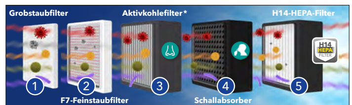
Der AirgoClean® One bietet ein zertifiziertes Mehrstufen-HEPA-Filterssystem nach EN 1822. Der Aktivkohlefilter (*) gegen Gerüche ist optional erhältlich.
