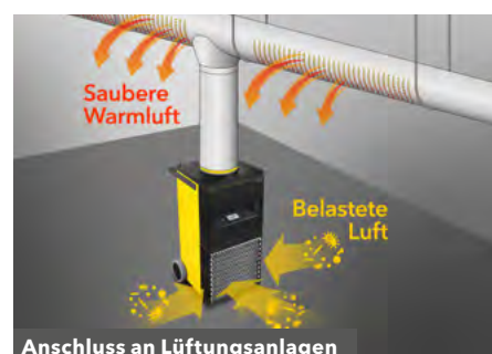
Anschluss an Lüftungsanlagen
